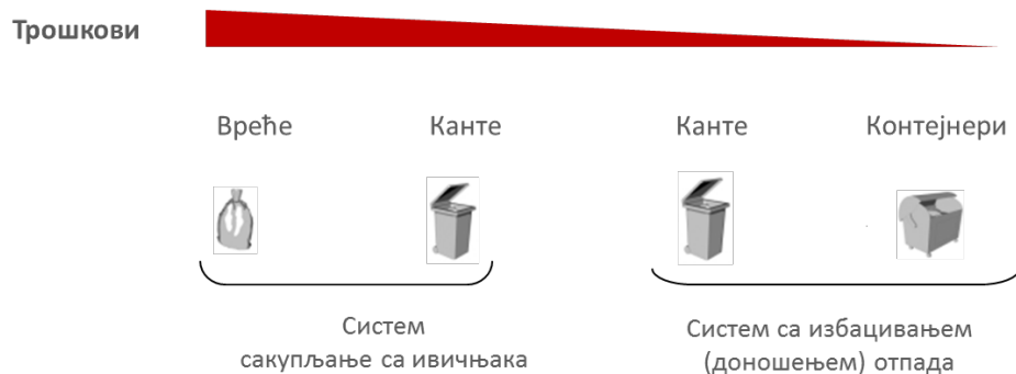
Слика 1.3 Схематски приказ система сакупљања са ивичњака и са избацивањем.
